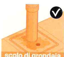
scolo di grondaia
